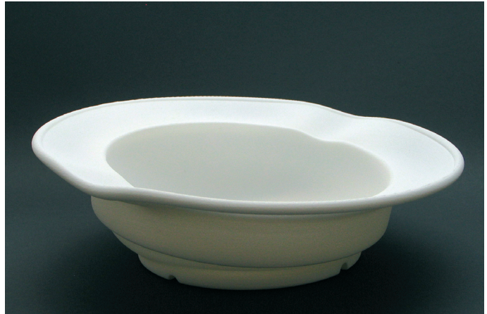
Abbildung 58: SLS-Modell der Schüssel.
