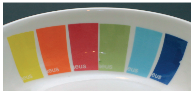
Abbildung 60: Inglasurfarben im Siebdruckverfahren. Die abgebildeten Farben entsprechen nur im Original den angegebenen Farbwerten.
