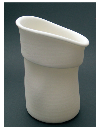
Abbildung 57: SLS-Modell des Bechers.
