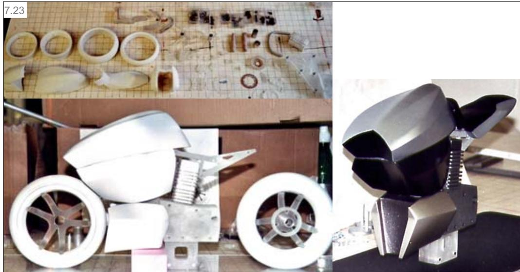
Abb. 7.23 Teile des Modellbaus aus dem 3D-Drucker
