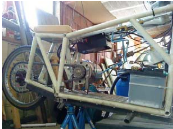
Abb. 63: Endmontage der Kraftübertragung
