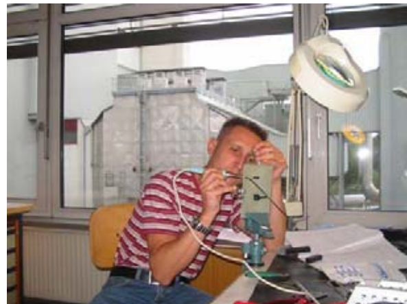
Abb. 67: Verlöten der PWM auf eine Platine
