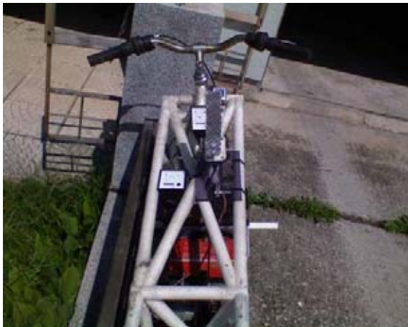
Abb. 37: Messinstrumente mit Kurzschlusschaltung
