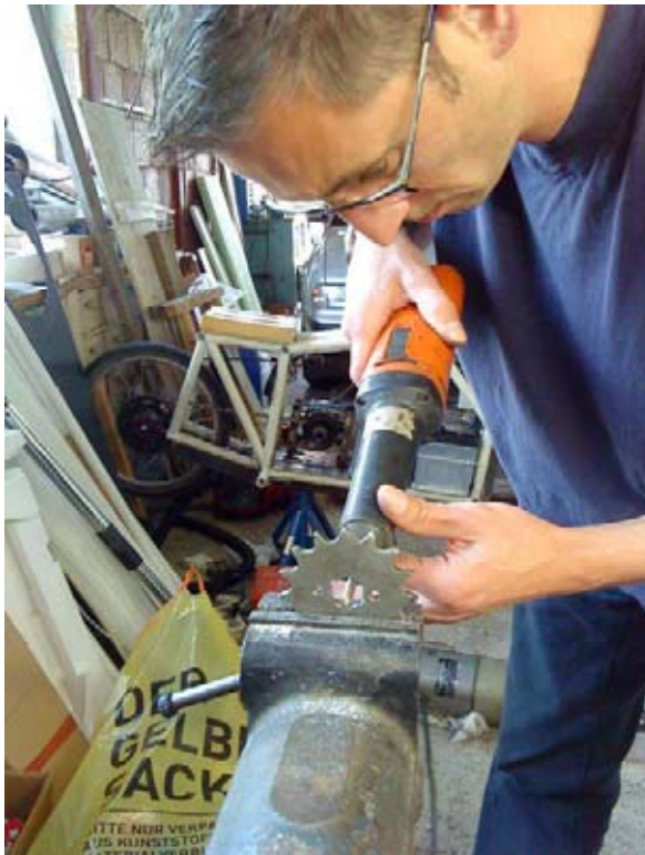
Abb. 56: Fräsarbeit am treibenden Zahnrad
